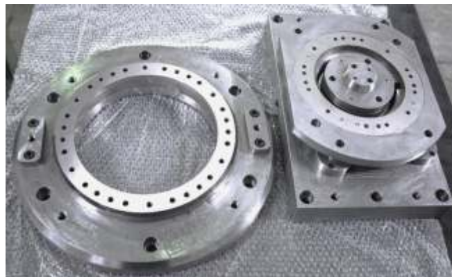
बीएचईएल भोपाल के लिए इलेक्ट्रिक मोटर के रोटर हेतु 270 शॉफ्ट होल टूल
